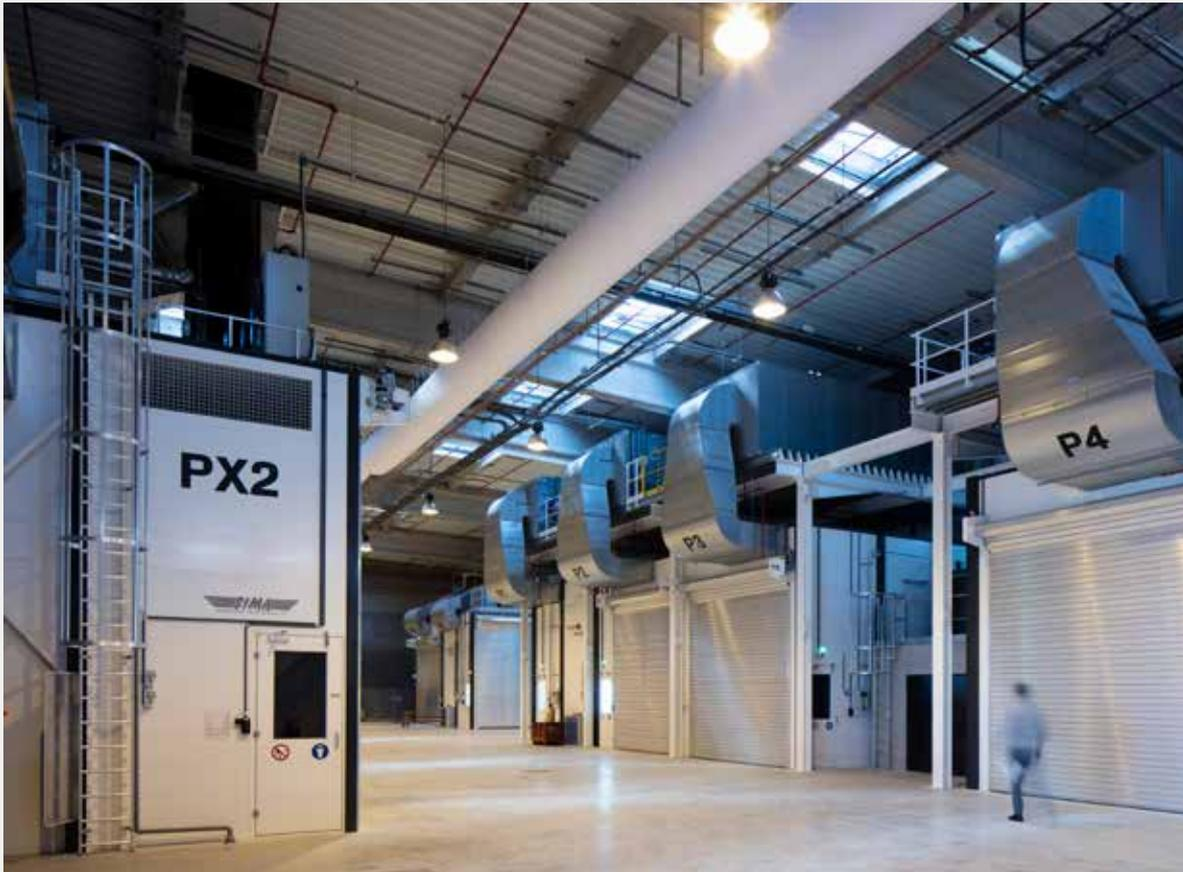
Dans l'industrie aéronautique aussi, il est possible d'opter pour la réalisation du processus complet sur une seule ligne (préparation, zone de lavage, peinture, four, etc.). Sima assure alors la conception, la production et le montage de lignes de peinture complètes. Ce processus peut être entièrement automatisé.
