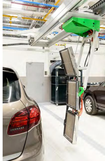
Le GDS E7 se monte sur des rails au-dessus de la voiture et peut se placer dans la cabine de peinture ou dans la zone de préparation. En mode repos, l'appareil se rabat complètement afin de préserver de l'espace utile dans l'atelier. Pendant l'utilisation, le capteur de distance intégré gère la distance optimale pour le séchage.
